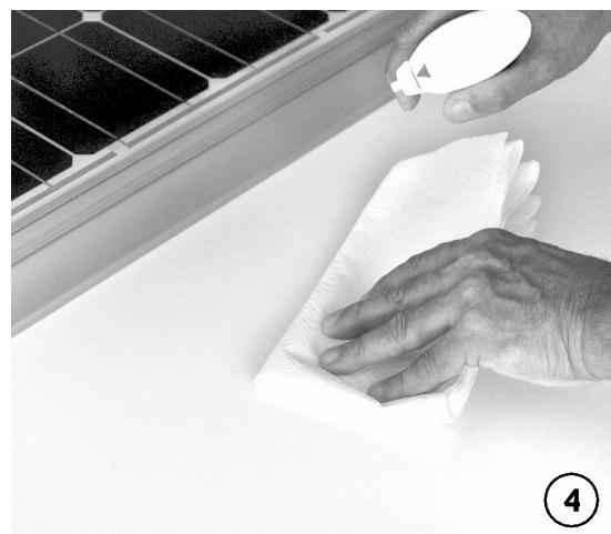
Nettoyez soigneusement le toit du camping-car avec un dégraissant et collez le support. Laisser sécher.
