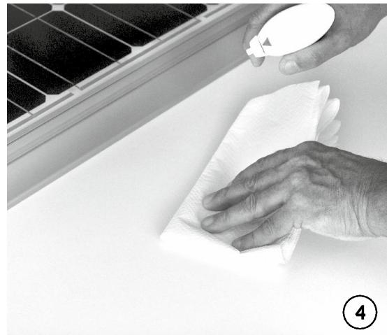
Das Dach mit einem Reiniger reinigen und den Spoiler aufkleben. Trocknen lassen.
