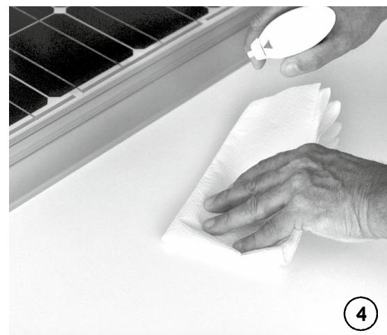
Pulire accuratamente con sgrassante il tetto del camper e incollare il supporto. Lasciare asciugare.
